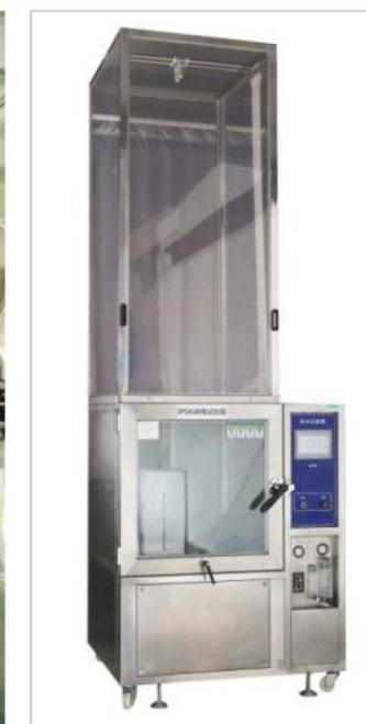
Тестовый стенд водонепроницаемости IP5/6
