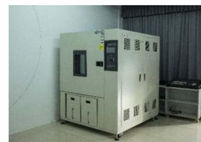
Программируемый стенд тестирования воздействия температуры и влажности
