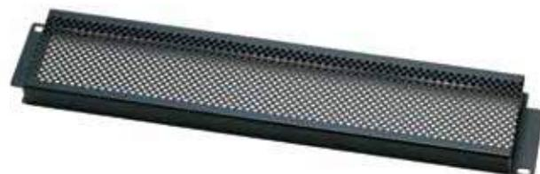
Передняя панель-заглушка, 2U, сталь (1,2 мм), отделка черного цвета RAL 9005, отверстия для вентиляции.
