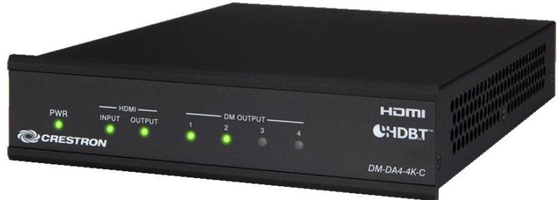
DM-DA4-4K-C является принадлежностью DigitalMedia™, которая преобразует и разветвляет один 4K60 HDMI® сигнал на четыре отдельных приемника DM 8G+® или HDBaseT®. HDMI выход предназначен для сквозной передачи сигнала на местный дисплей, звуковой процессор, коммутатор или другой DM-DA4-4K-C. Видео и звук поступают со входа на все пять выходов одновременно и без каких либо изменений и искажений.
