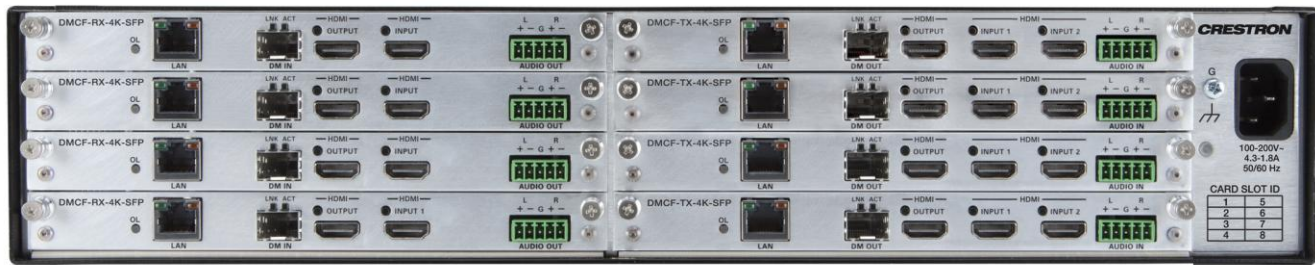
DMF-CI-8 – Вид сзади с установленными картами
