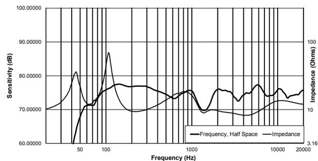
Частотная характеристика и сопротивление при 1 Вт/4 м/по оси (с коррекцией АЧХ согласно требованиям стандарта EN54)
