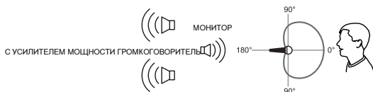
Рекомендуемое расположение громкоговорителей для кардиоидных микрофонов
