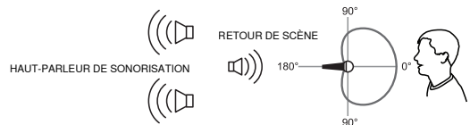
Emplacements recommandés des haut-parleurs pour les microphones cardioïdes
