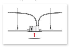
**Install Cable/Conduit Access Plate**
